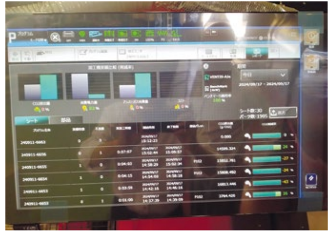
工場の見える化により製造工程だけでなくCO 2 排出量、消費電力量なども把握
