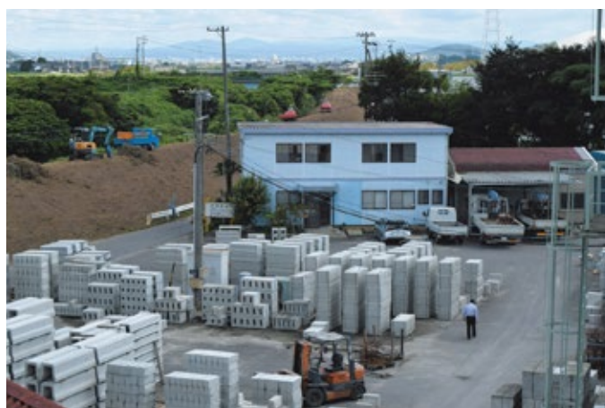
U字溝や集水枡などコンクリート2次製品を製造
