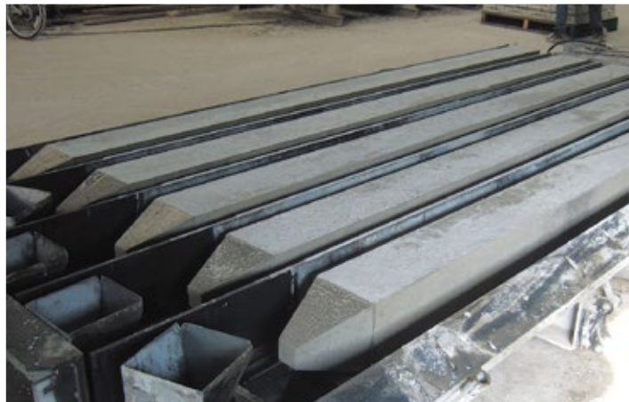
スライド式型枠のため、脱型作業効率も向上
