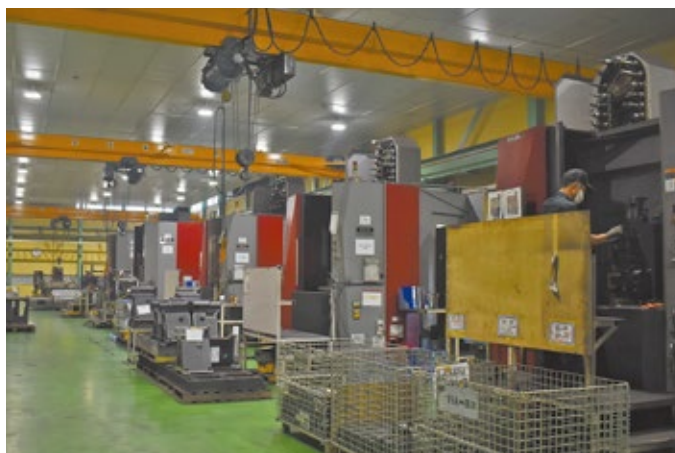
横形MCによる高効率加工を追求
