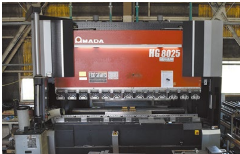
高精度曲げ加工を実現するハイブリッドベンダー
