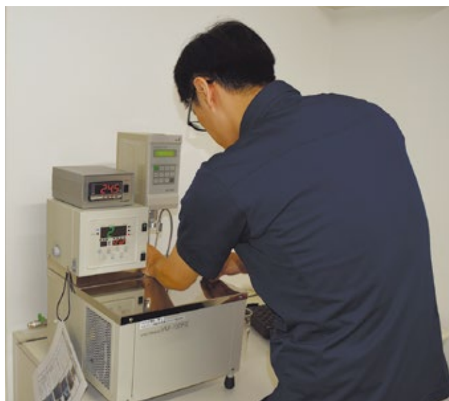
粘度計で液体材料の特性を把握する
