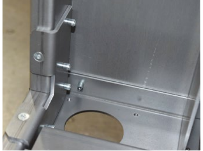
パネル部材をリベット工法で固定・締結
