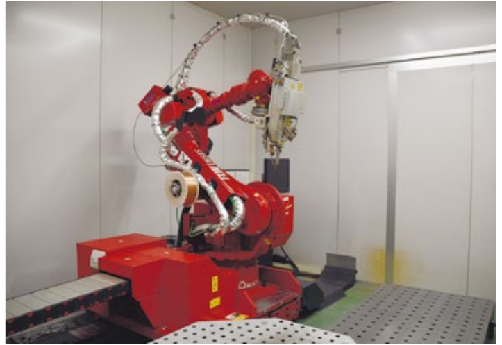
製作期間の短縮に効果を発揮しているファイバーレーザー溶接システム
