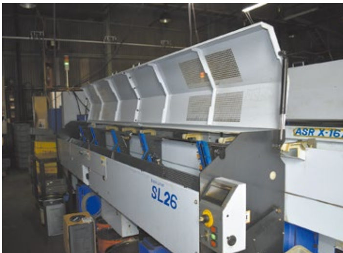
長尺材対応のバーフィーダーを導入
