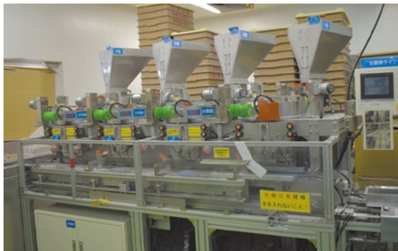
不良発生率を低減した新型の餅あめ供給機
