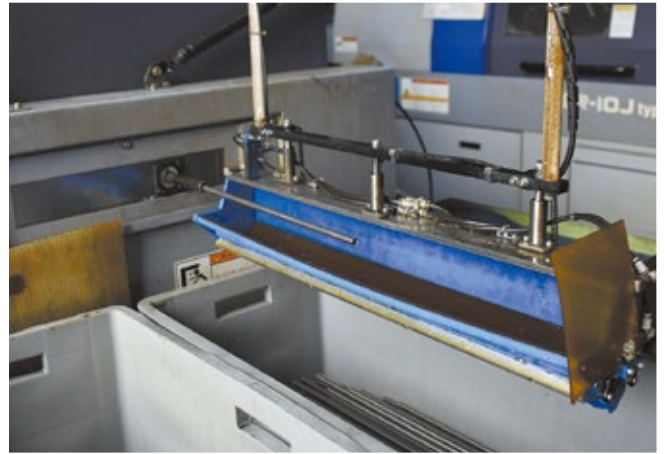
加工済み製品を自動搬送機でストックする
