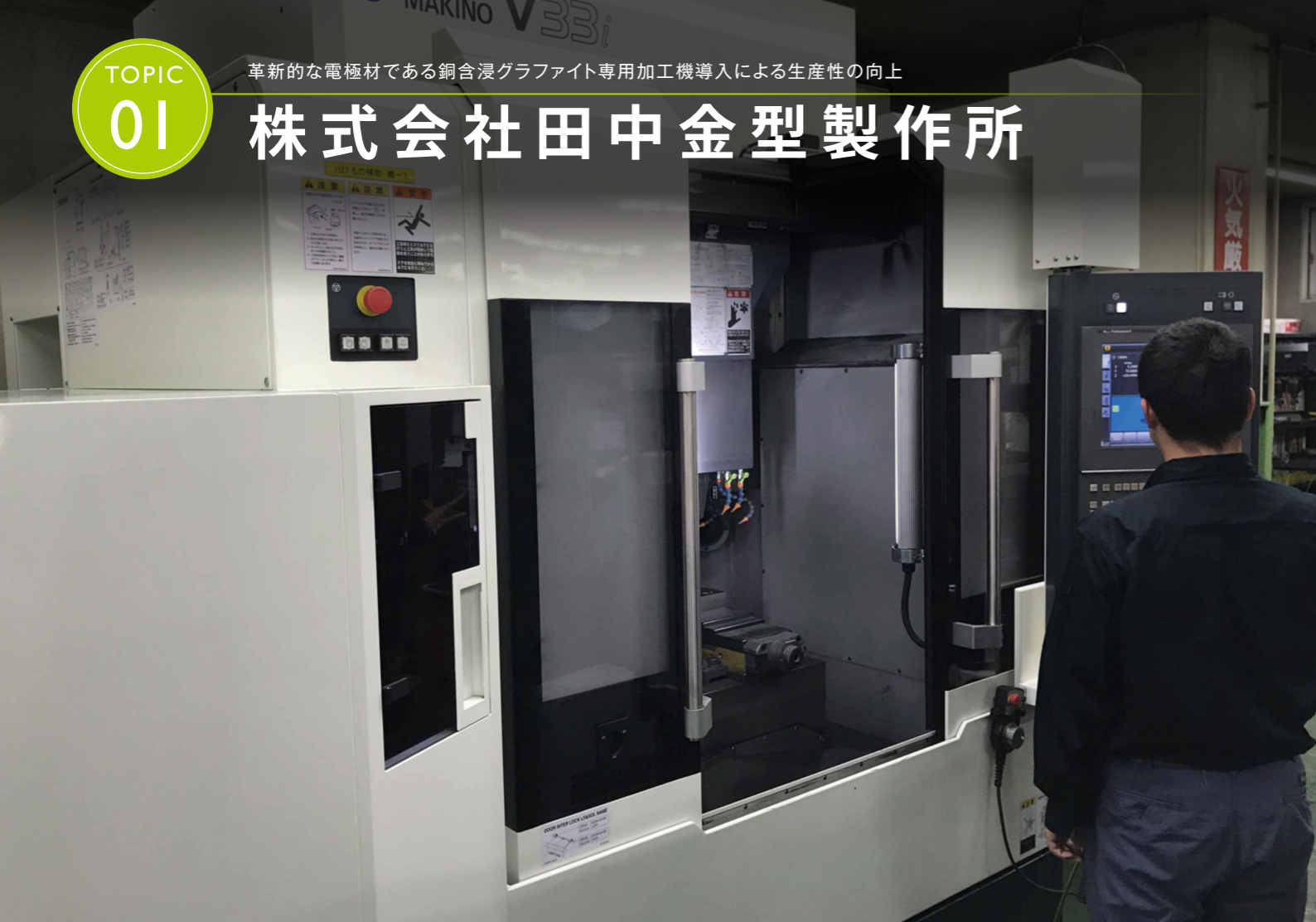
最新電極加工機の導入による、銅含浸グラファイトを活用した金型製造技術と生産性の向上
