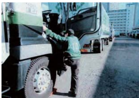
墜落・転落防止:三点支持の徹底
