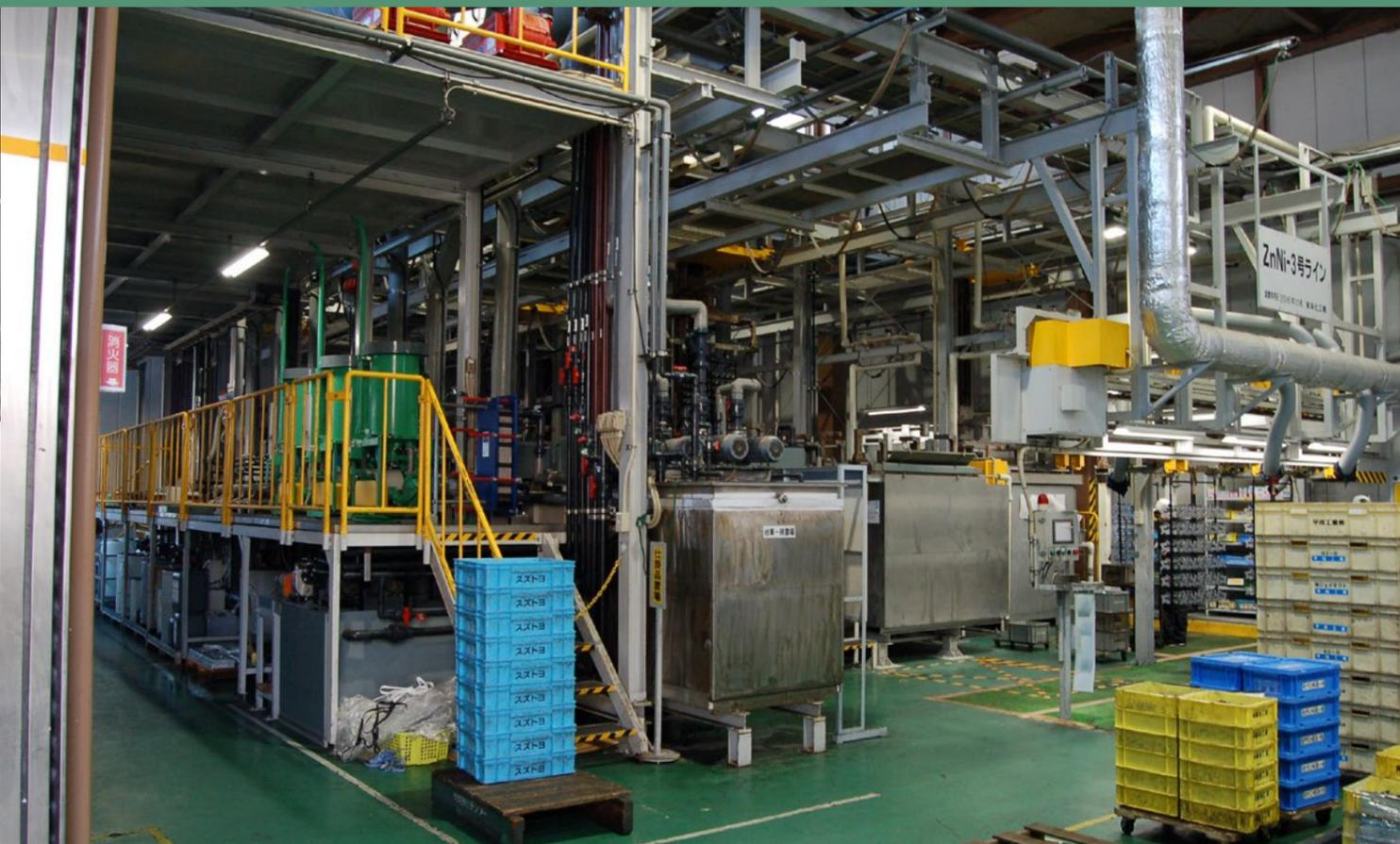
■ 開発した隔膜電極方式のメッキライン
