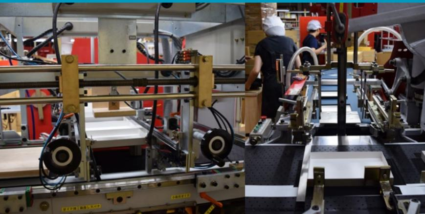
■ 三つのセンサーで距離を測定し、位置合わせする
