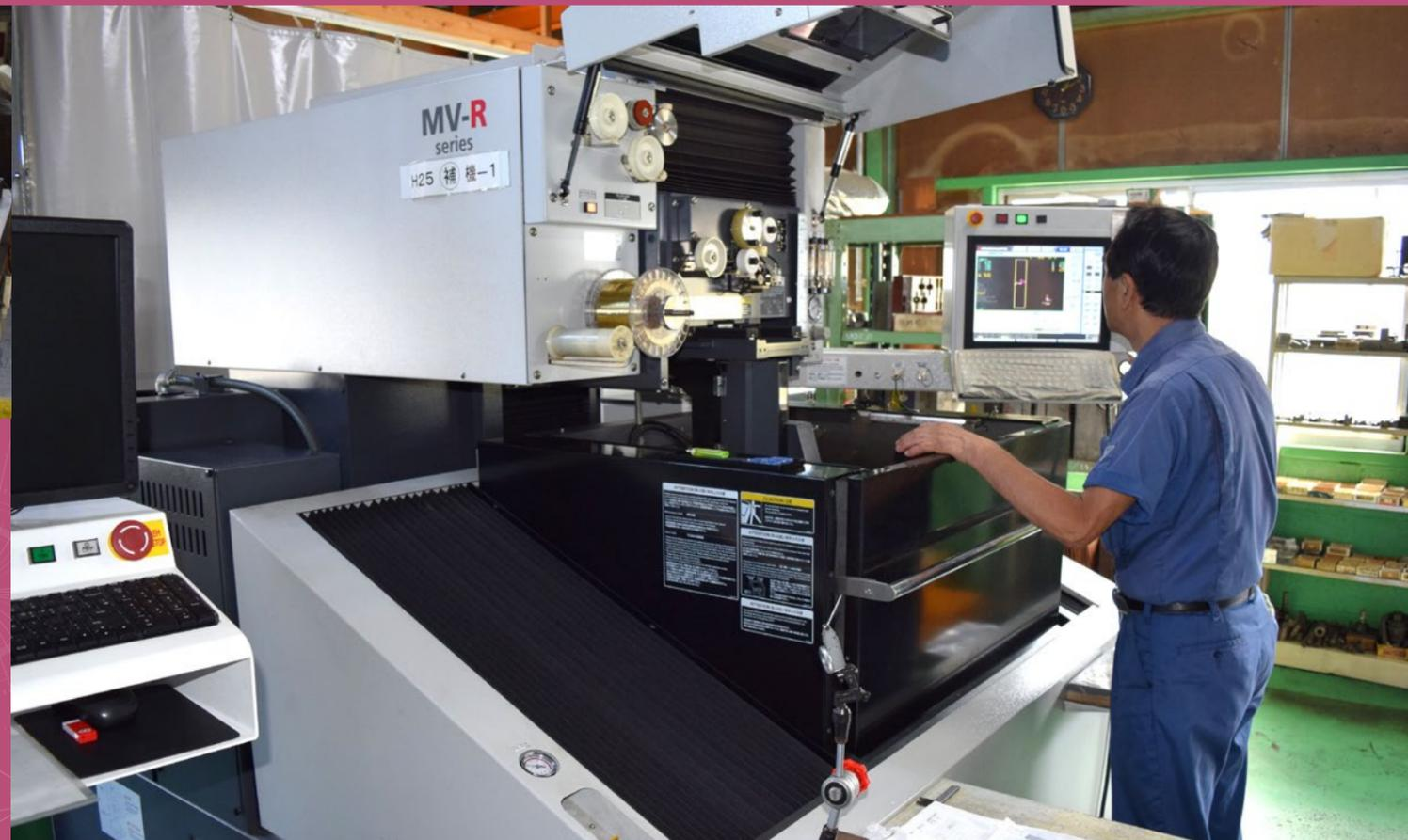
■ 金型部品の高精度加工を支えるワイヤ放電加工機
