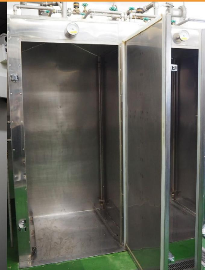
■ 袋詰めした麺を深蒸しする一山機械製蒸し器
