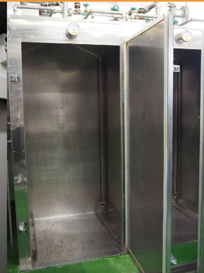
■ 袋詰めした麺を深蒸しする一山機械製蒸し器
