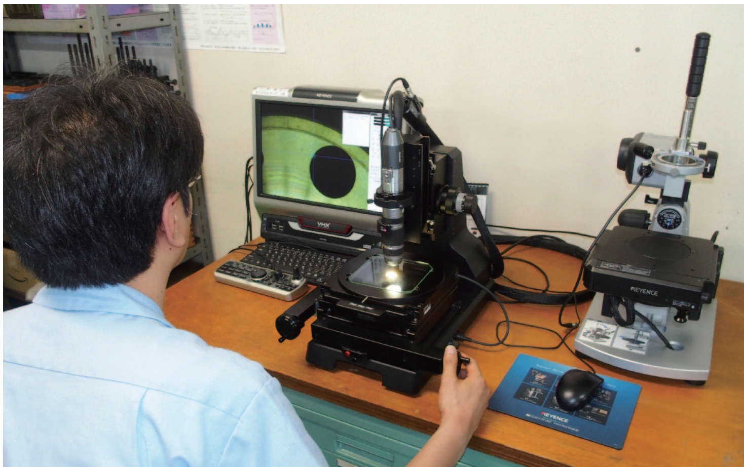
導入したマイクروسコープ。精密加工・微細加工の実際の形状を拡大して画像で表示できる
