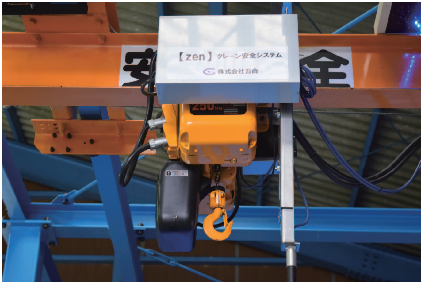
実験棟の天井クレーン。操作情報と移動情報を管理する基板を内蔵
