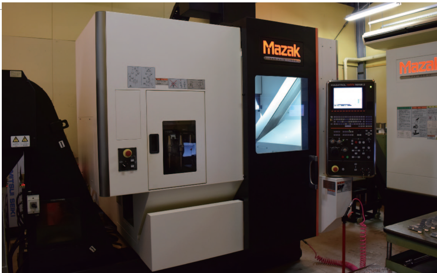
導入したヤマザキマザックの5軸マシニングセンター。航空機部品の加工能力が大幅に向上した
