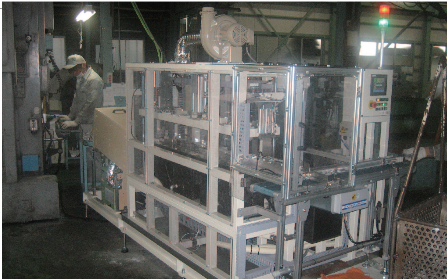
ものづくり補助金で新開発した潤滑剤塗布装置。自社製品「フロージット」を改良した
