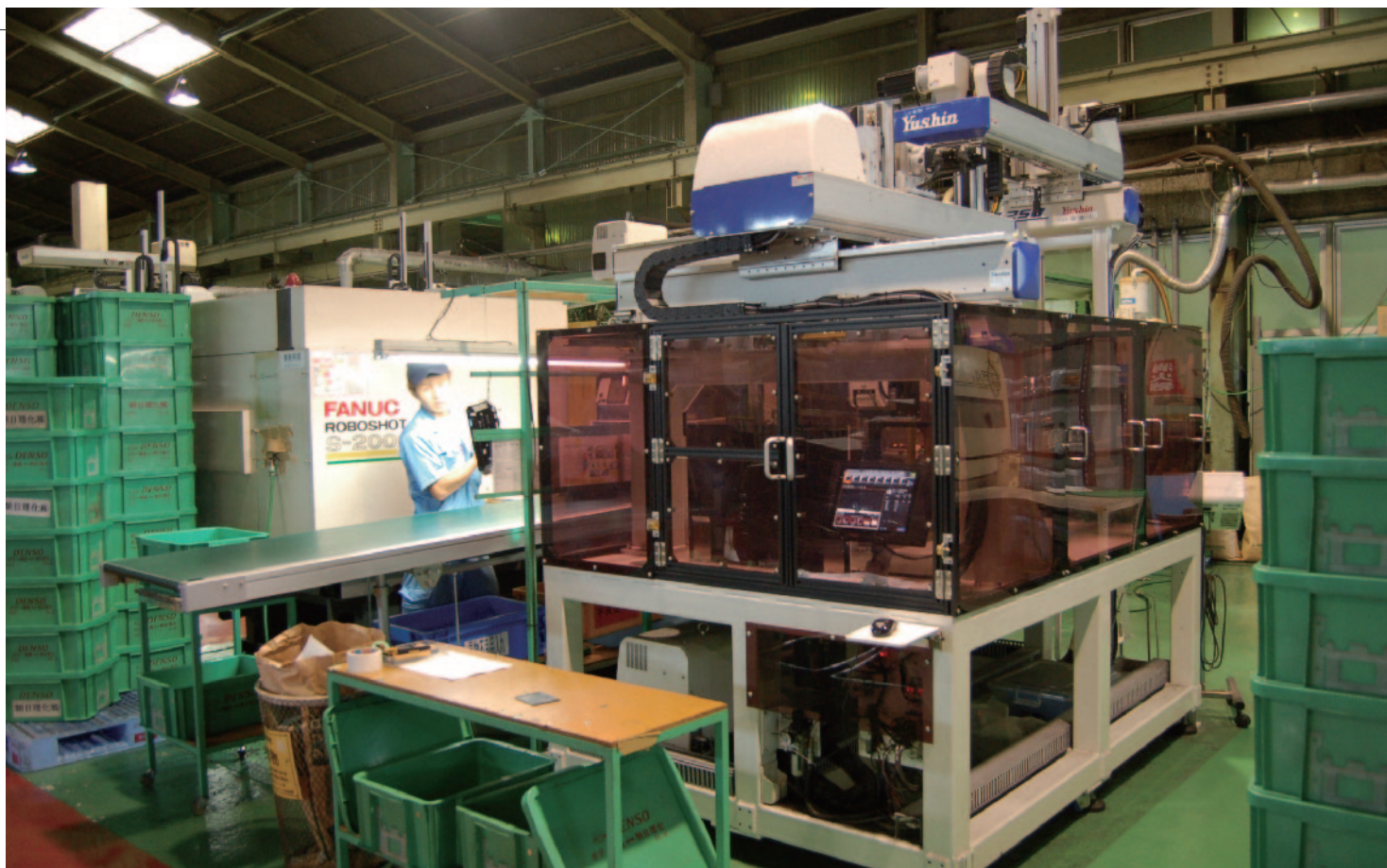
不良品流出ゼロと省工程化実現のため導入した高性能複眼検査システム
