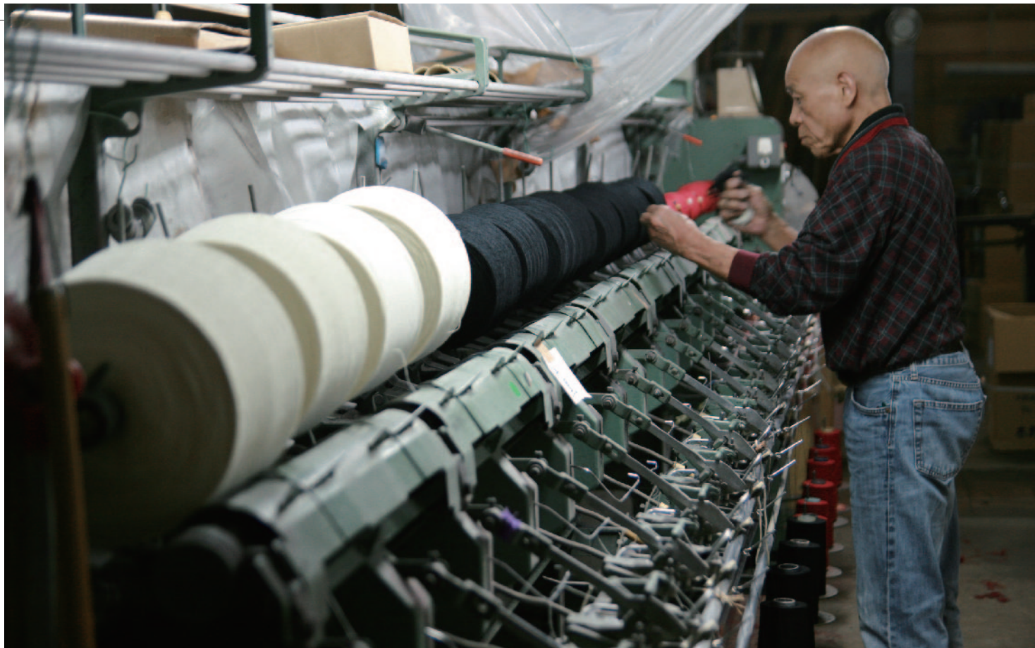
工場内の湿度や糸のテンションを一定に保って糸を巻き替える繊細な作業
