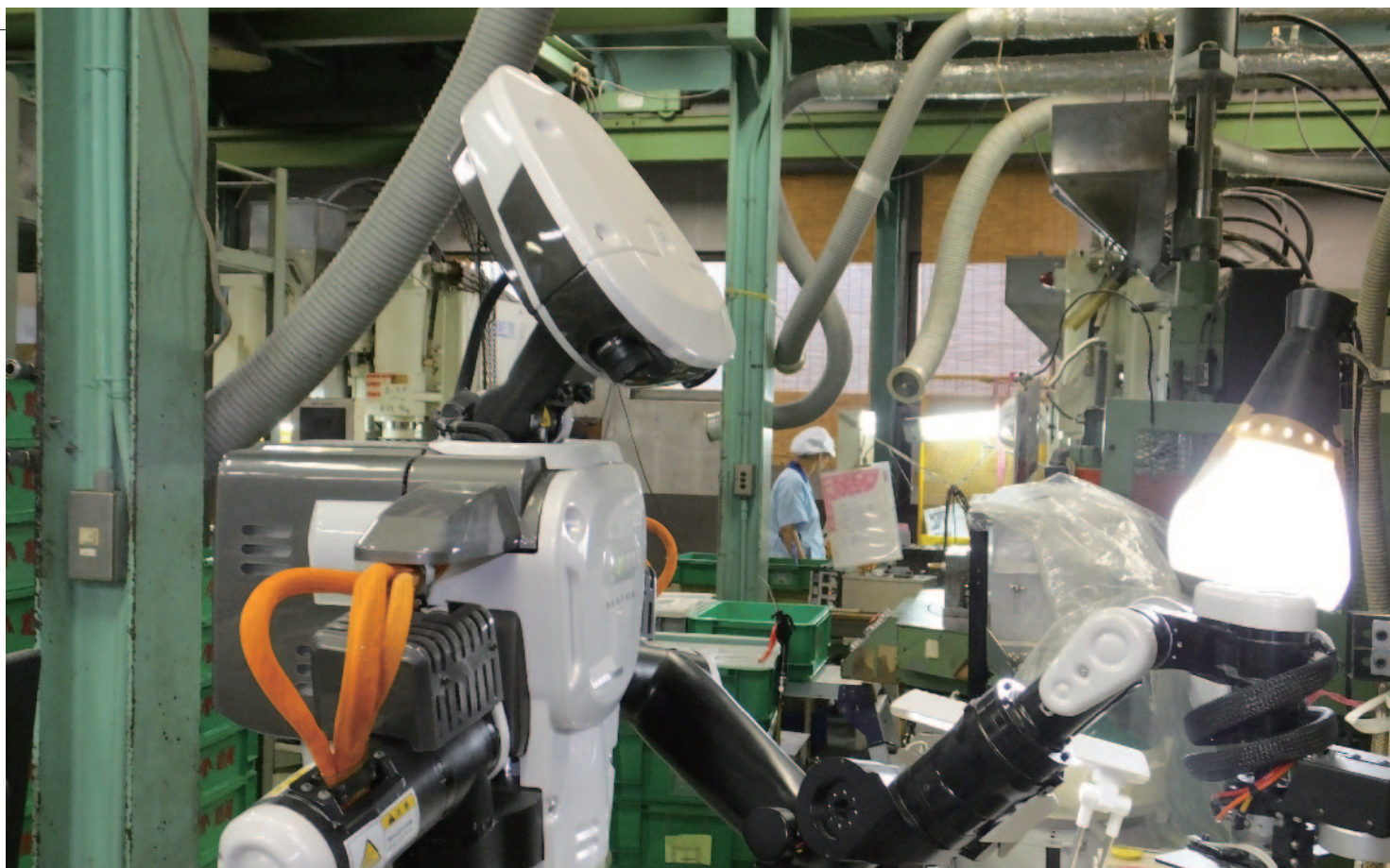
人型工業用ロボット「ネクステージ タイプC」。射出成形業界でこのロボットの導入事例はまだ少ないという
